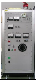
耐電圧試験機 フジクラ・ダイヤケーブル製 部分放電測定可
